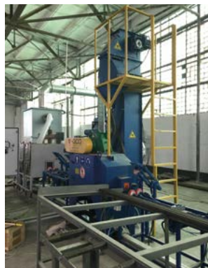
Трубный дробемет ДПУ 108х1Т
