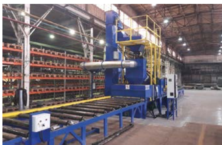
Проходная дробеметная установка ДПУ-1.6х0.6-4
