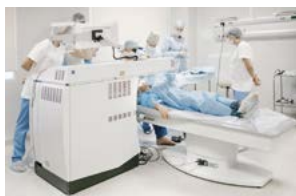
Офтальмологический эксимерный лазер MEL 90 компании Carl Zeiss
