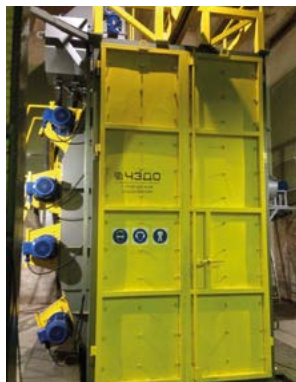
Подвесная дробеметная установка ДТУ 4х4-4
