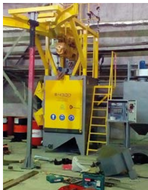
Подвесная дробеметная установка ДТУ 1.2х1.2-2
