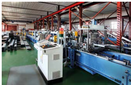
Цех по производству ЛСТК (оборудование IL KWANG METALL FORMING (Южная Корея), ROLLSTEEL MACHINE OY (Финляндия))
