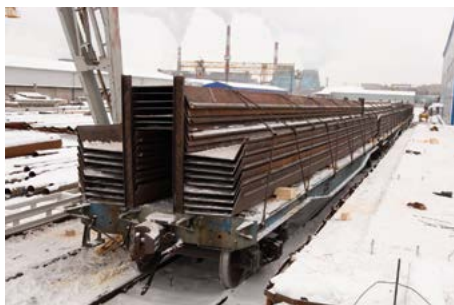
Шпунт СШК на 19 метровых ж/д платформах для Курской АЭС-2
